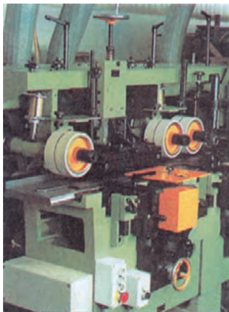
شکل ۴-۲۸- دستگاه فرزاوماتیک
